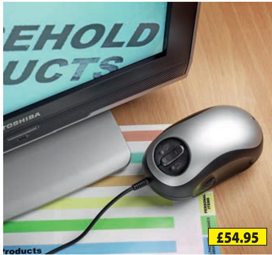
Ovo lagano i za upotrebu jednostavno ručno povećalo, veličine je računalnog miša. Jedinica se spaja izravno na TV ili preko USB konvertera na računalo. Kotačići omogućuju čitatelju lako pomicanje. 7 razina zoom-a daju do 70x povećanja na 20" zaslonu (povećanje ovisi o veličini zaslona – što je veći zaslon, veće je povećanje). Modovi prikaza su; crna pozadina s bijelim tekstom, visok i nizak kontrast - bijela pozadina s crnim tekstom ili u punoj boji.
